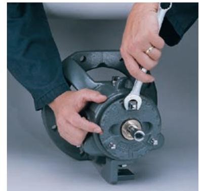
**Paso 3:** Gire el soporte del rodamiento en sentido horario hasta el número seleccionado de muescas. Apriete los tornillos de fijación y verifique la holgura del impulsor con el calibrador de láminas o galga de espesores.
