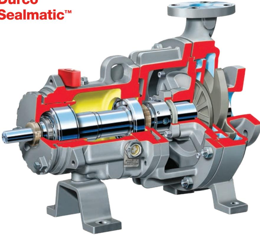
Con la bomba Durco Mark 3 Sealmatic, no se necesita sello mecánico durante el funcionamiento. Un expulsor de sellado dinámico expulsa fluido de la cámara del sello, lo que hace que la bomba Sealmatic sea ideal para aplicaciones difíciles de sellar. Vuelve innecesarios la purga externa y el control de la contaminación del proceso. Cumple las normas ASME (ANSI) B73.1.
