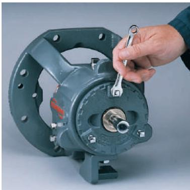
**Paso 1:** Afloje los tornillos de fijación. Con la ayuda de una llave, gire en sentido antihorario el soporte del rodamiento hasta que el impulsor de álabes invertidos toque levemente la placa de la cubierta posterior.
