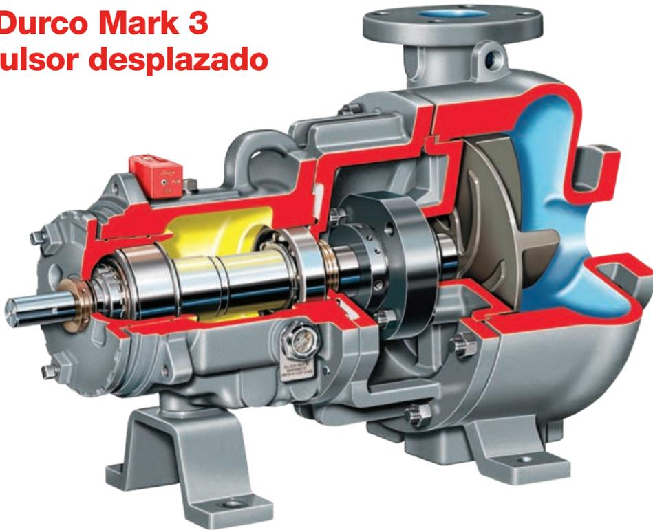
La bomba Durco Mark 3 con impulsor desplazado combina las mejores características de diseño de la bomba estándar Mark 3 ASME (ANSI) con la acción de vórtice de un impulsor desplazado. Estos, junto con los componentes de paredes gruesas del extremo húmedo, prolongan la vida útil de la bomba y el sello (o prensaestopas) al manipular lodos con sólidos, filamentosos o fibrosos.
